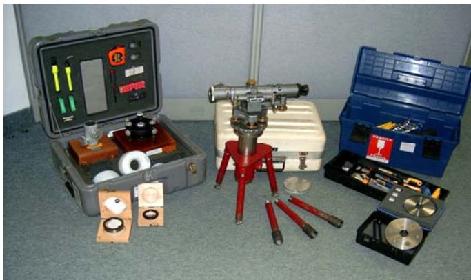
Instruments optiques OASIS employés spécifiquement pour l'alignement d'extrudeuses et de lignes de pellicule plastique.
