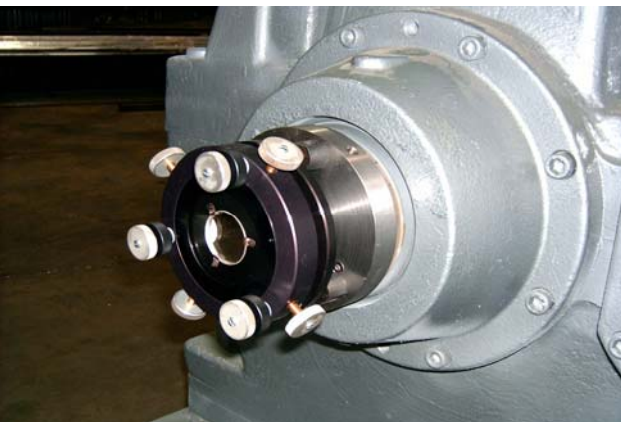
Installation OASIS - Établissement d'une référence d'alignement sur l'arbre de sortie du réducteur d'une extrudeuse
