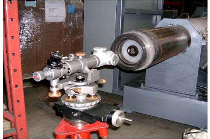
Installation OASIS – Mise en place d'un instrument optique et d'une cible dans l'ouverture du baril d'une extrudeuse
